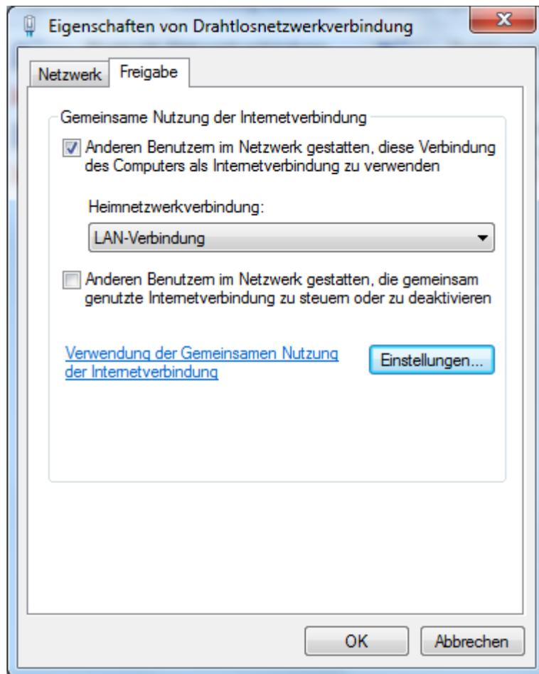
Anschließend die Adaptereinstellungen schließen, den UP4DAR über ein Ethernet-Kabel an die LAN-Schnittstelle des Laptops anschließen und funken.
