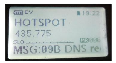
MSG: DCS009B DNS request (er versucht sich also zu DCS009B zu verbinden).
